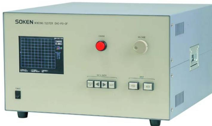
DAC-PG-3Fは低圧回転機巻き線試験用のインパルス試験機です。本装置はサージインパルス発生回路、相切り換え装置（U-V-Wの切り換え）、波形記録回路で構成されており、自己比較型のインパルス試験装置です。波形観測装置として、TFT液晶表示器を採用しており波形の視認性に優れております。記録された波形をデジタルストレージし、パルスの出力頻度が低く供試品に不要なストレスを与えません。さらに、試験相の切り替え装置を内蔵しておりますので、波形の観測、各相ごとの比較を極めて容易に試験を行うことができます。
