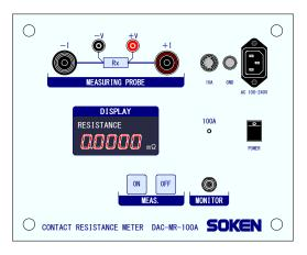
低抵抗測定において $0.1\mu\Omega$ 以下の分解能を必要とする場合、従来は精密ダブルブリッジが使用されておりました。本器は分解能が高く簡単な操作で超低抵抗が測定できます。
