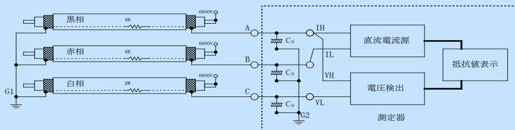
黒相の抵抗を測定する場合、A-B間のしゃへい層に直流電流を流しA-G1間の電圧降下をA-C間で検出して抵抗値を表示します。しゃへい層断線時もコンデンサ経由G2で設置される為安全です。
