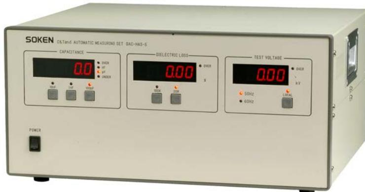
高圧非接地機器の静電容量とtan  $\delta$  を測定するもので、2種類の標準コンデンサを選択することができます。静電容量及びtan  $\delta$  が広範囲に測定できるため、碍子、変成器、パーコイルなどの出荷試験にご利用頂けます。また、バランススピードが速いため、電圧特性試験に最適な測定器となります。
