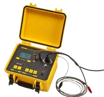
各装置は試験電源内蔵の  $\tan \delta$  測定器で、電力用変圧器、電力用ケーブルの乾燥管理にご使用頂ける試験装置です。アナログ出力を備えており  $\tan \delta$  及び静電容量の値を連続的に測定することで絶縁層の乾燥状態を監視できます。
