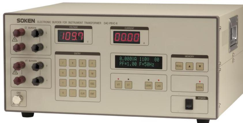
本装置は計器用変成器(VT・CT)の誤差試験用に開発された電子式負担装置です。テンキーにより負担や力率などの設定が容易にできます。USBインタフェースを装備していますので変成器誤差試験装置(DAC-VCTT-8)とパソコンによる自動試験システムにも対応できます。
