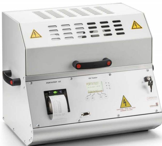
ポルタテスト A-3 シリーズは、電気絶縁油の破壊電圧を自動で測定する試験装置です。実験室だけでなく、現場での試験でも快適に操作できるよう設計されています。JIS、ASTM、IEC など、国内外の試験規格に対応したテストシーケンスがプログラムされており、メニュー画面からシーケンスを選択するだけで、希望の試験が自動的に実行されます。標準シーケンスに加え、ユーザ独自のプログラムを最大 10 個登録し、実行することができます。
