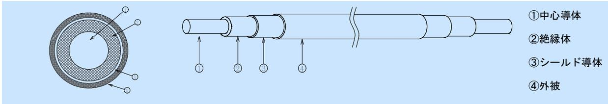
一般的に、①と③の間を、②を誘電体として静電容量と  $\tan \delta$  を測定します。
