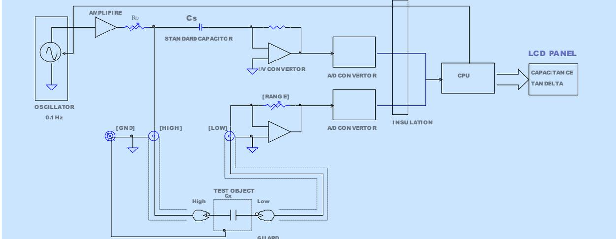
発振器で生成された低周波信号は電力増幅され基準電圧  $E$  を出力します。
