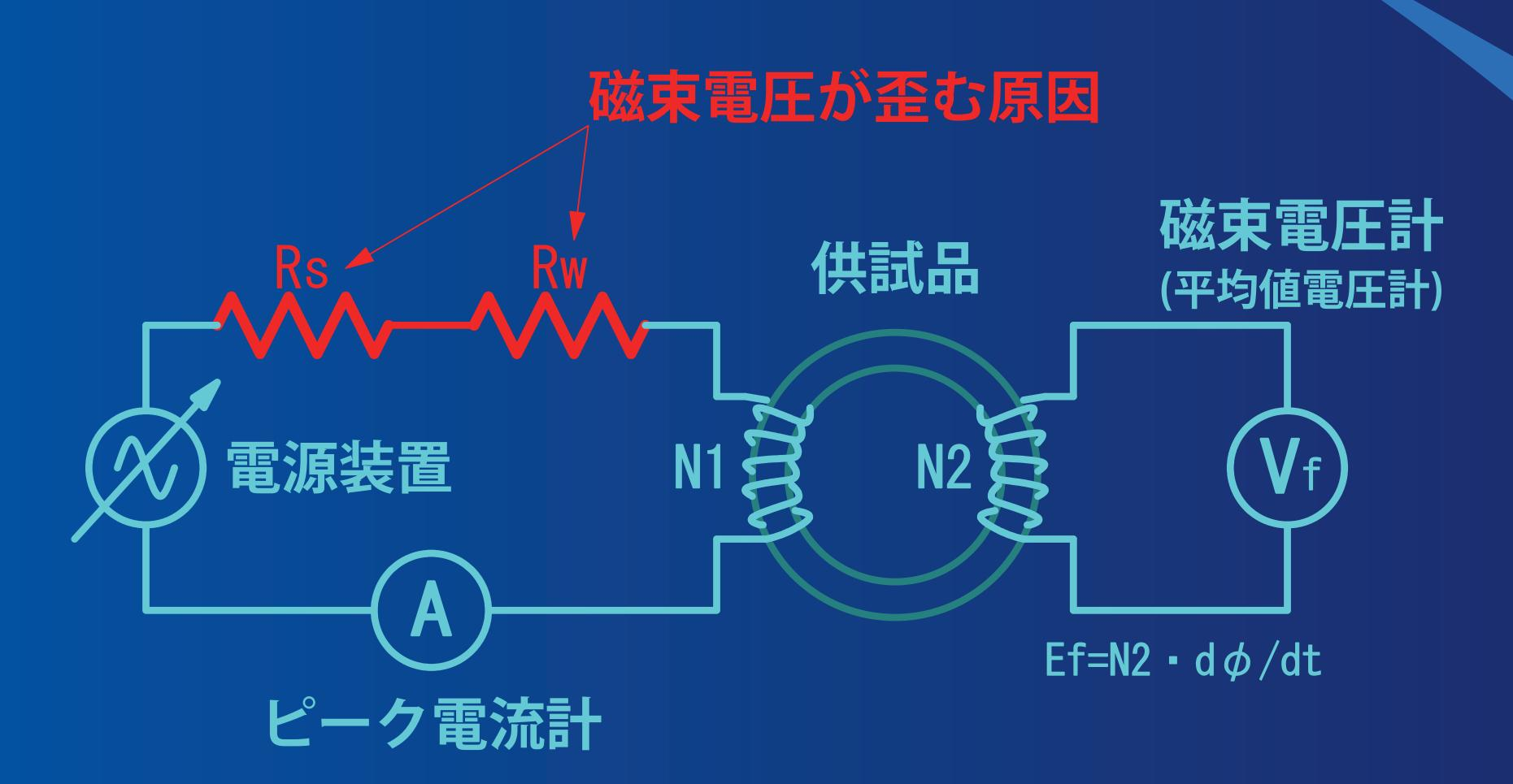
回路抵抗に励磁電流が流れると、 磁束電圧は励磁電流のピーク付 近で瞬時的に電圧降下する。
