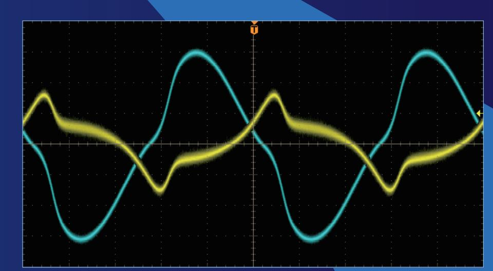
磁東電圧が歪むと励磁電流が流れ難くなり、結果的に磁性材料を過大に評価してしまいます。
